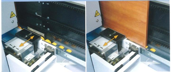
Einfaches Einstellen der Spannange (manuell) auf Werkstückdicke (Spannzangenhub 10 mm). Bei Werkstückdickenunterschieden von bis zu 10 mm ist keine manuelle Einstellung der Spannange notwendig.
