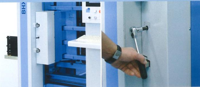
Einfaches Anpassen an unterschiedliche Werkstückdicken. Die einzustellende Werkstückdicke kann optisch über die Anzeige am Bildschirm kontrolliert werden.
