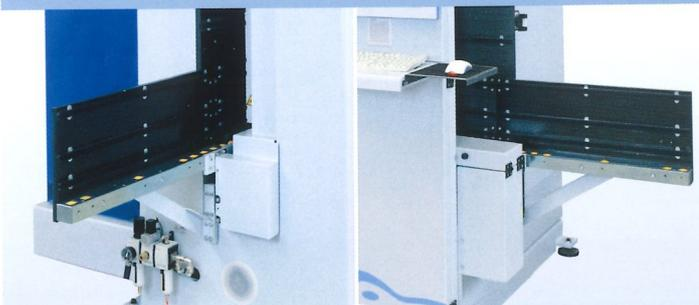
Mechanische Unterstützung mittels einer Röllchenbahn im Belege- und Entnahmebereich der Maschine.
